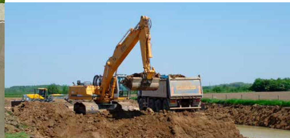
Voor de kleiwinning wordt een hydraulische graafmachine ingezet om de vrachtwagens te beladen. De vrachtwagens laden de klei in een schip.
